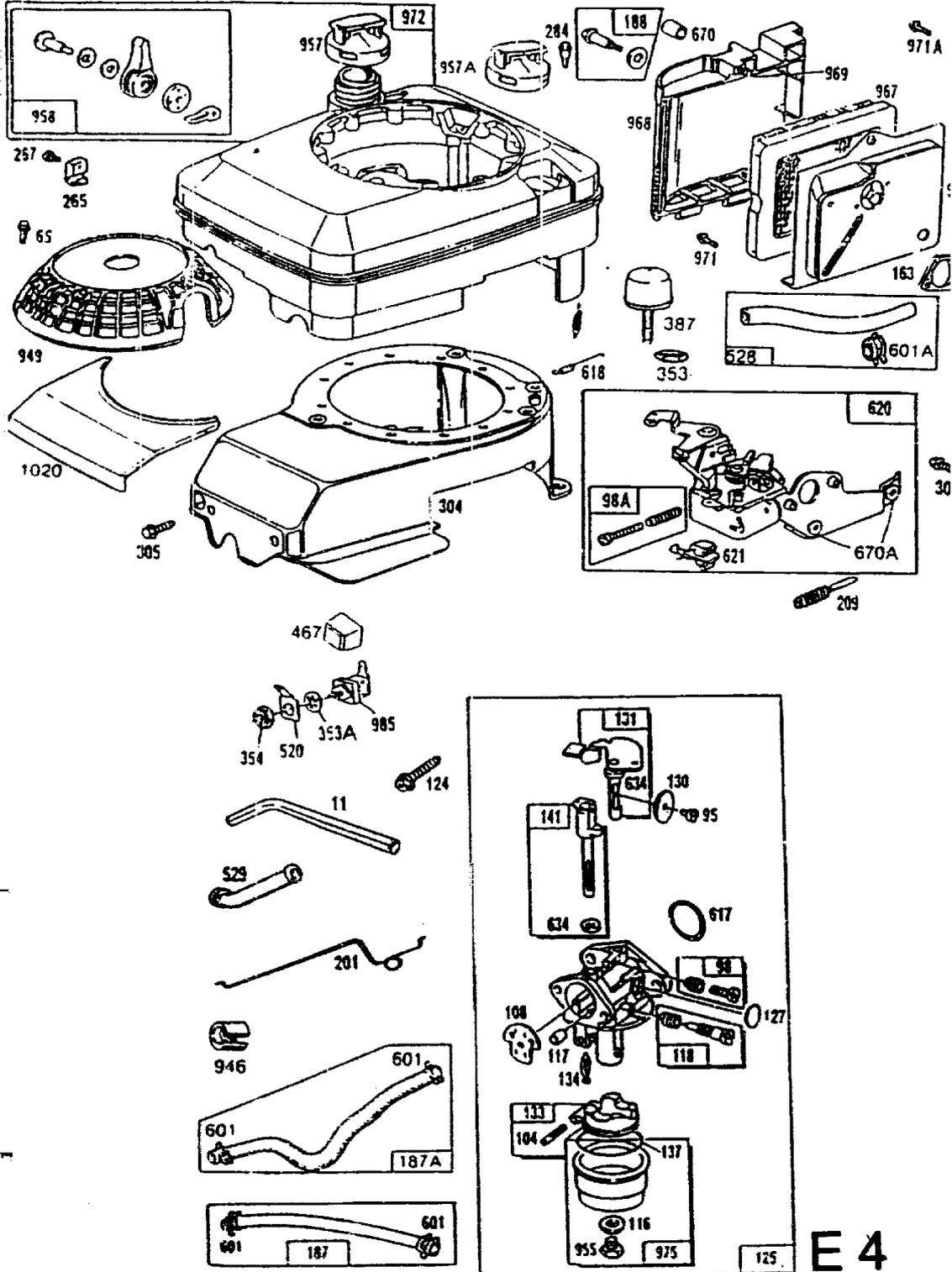
Vergaser, Tank und Filter 4,0 HP Quantum
