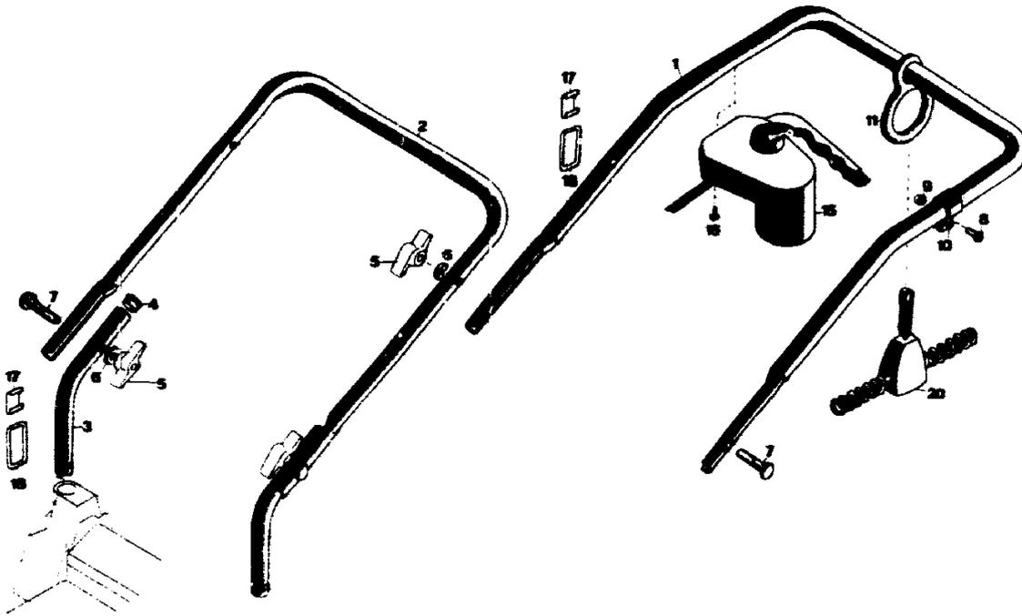
Ersatzteile TE 40 CN Griff- und Schaltteile
