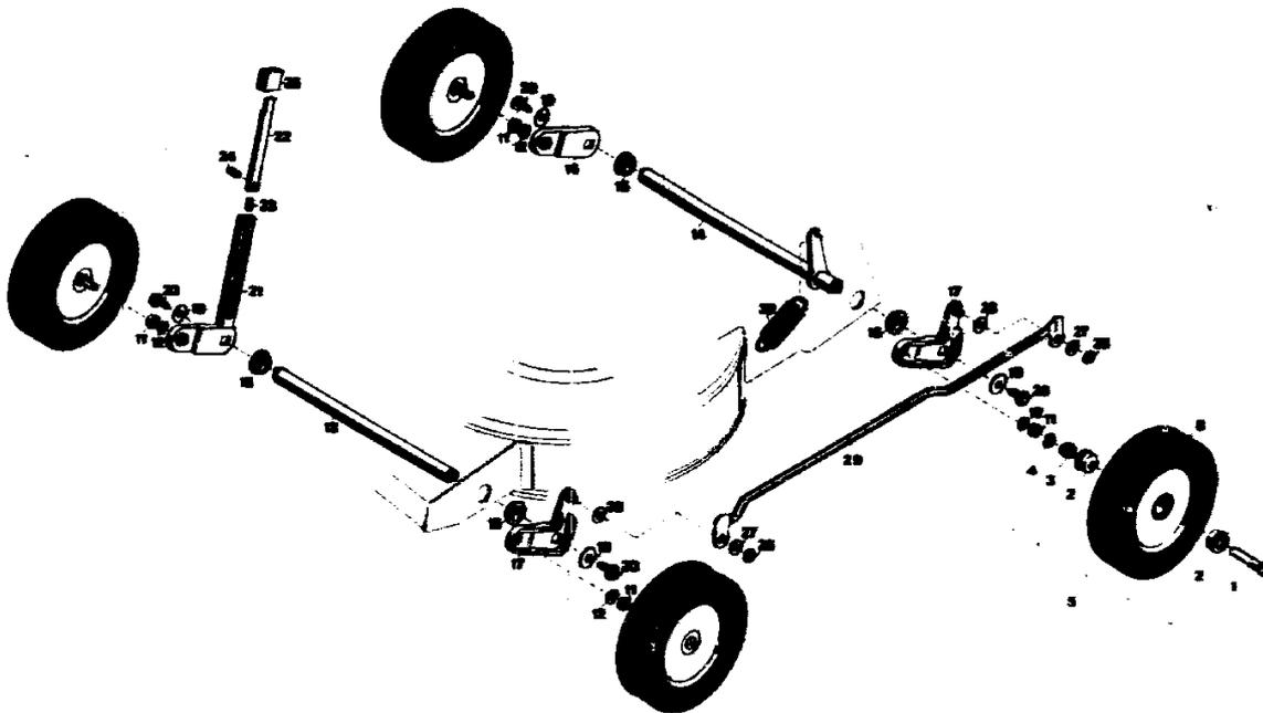
Ersatzteile Laufräder mit Höhenverstellung
